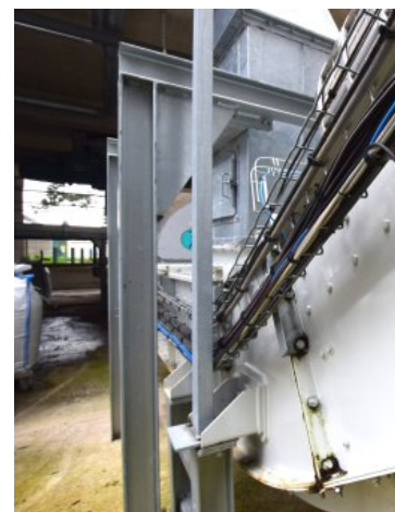
Convoyeur intérieur protégé par un détecteur d'étincelles GreCon, photo FD
